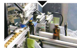
内栓・キャップの取り付け Capping and plugging
