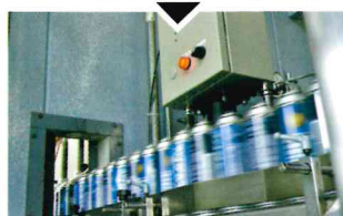
自動検圧機でチェック Automatic pressure gauge check
